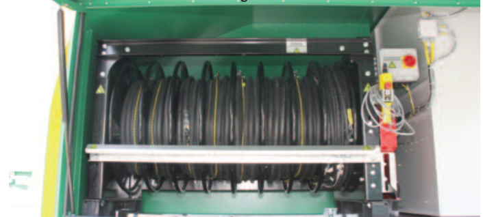
Die Kabeltrommel verfügt über 7 x 30 Meter Kabellänge und kann elektrisch mittels Handtaster ab- und aufgerollt werden.
